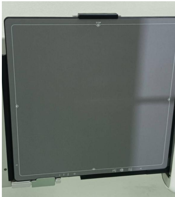
รูปที่ 2 แผ่น Digital Flat panel X-ray Detector เครื่องหมายการค้าซัมซุง (SAMSUNG: S4343-W) (ที่มา:ภาพจากโรงพยาบาลชัยนาทนครินทร์)
